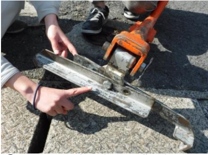
①アームの爪部の幅を側溝の幅に合わせます
